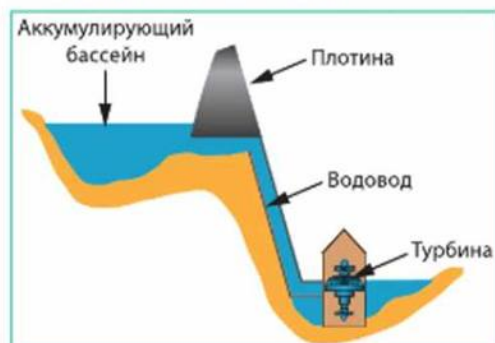
Рис. 10.6. Аккумулятирование потенциальной энергии большими массами поднятой воды: а — накопительный бассейн; б — схема спуска воды к турбине
